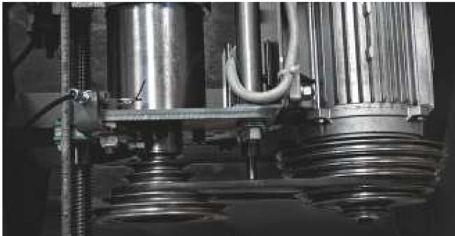
MÁQUINA EQUIPADA COM UMA 6ª VELOCIDADE
