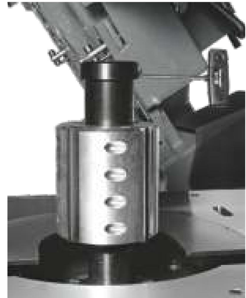
Sistema de bloqueio e desbloqueio rápido sem necessidade de utilizar utensílios.
