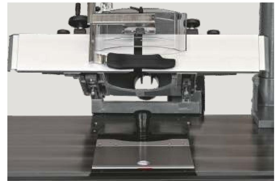
A mesa de trabalho seccionada pode ser ajustada sem a necessidade de ferramentas, devido a um suporte que destrava, trava e posiciona simultaneamente a mesa deslizante garantindo o máximo suporte à peça de trabalho.
