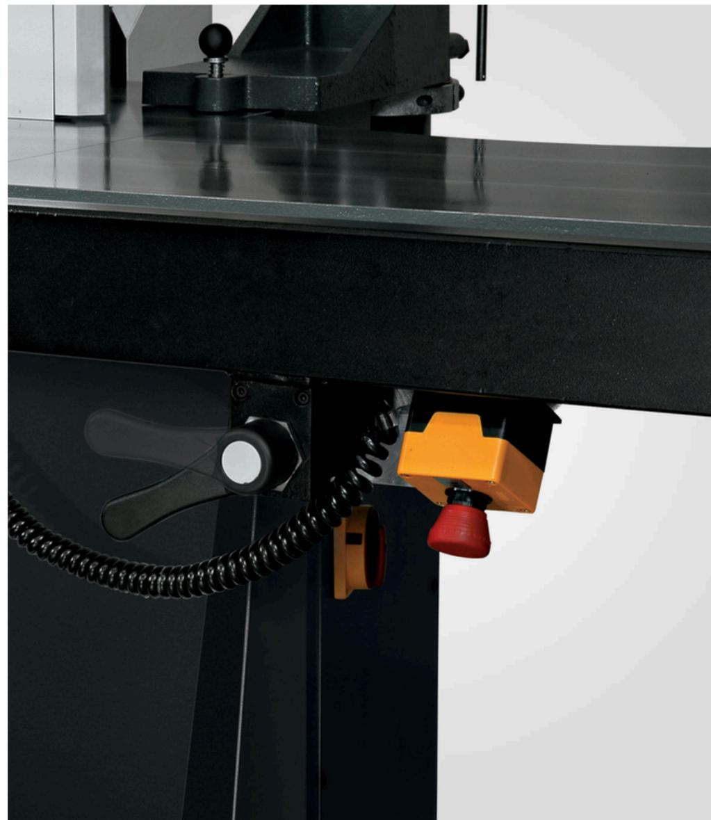
EQUIPADA COM DUAS ALAVANCAS QUE TRAVAM E DESTRAVAM DE FORMA RÁPIDA E FÁCIL COM UMA ROTAÇÃO DE 90°.
