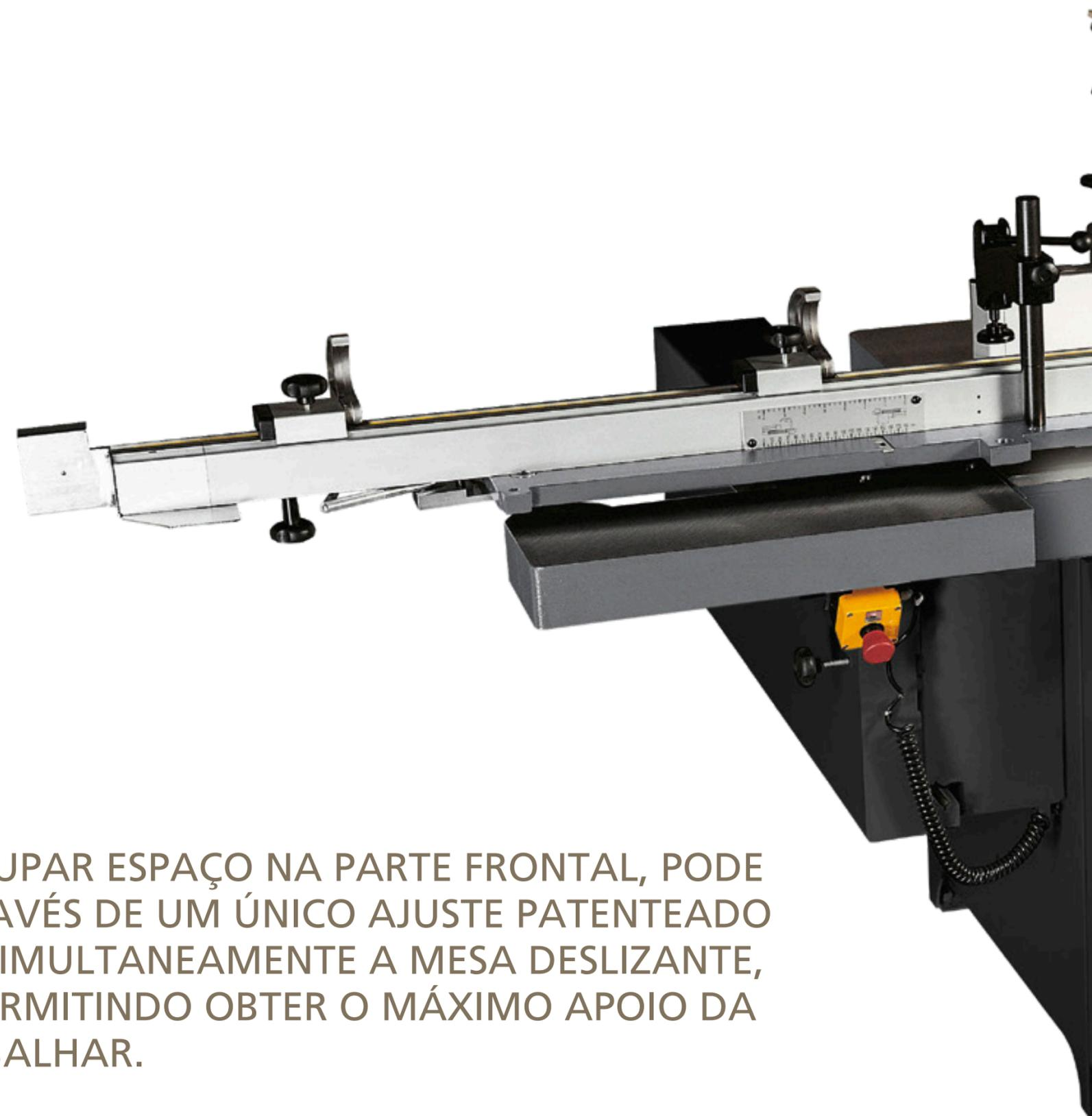
A MESA DE TRABALHO SECCIONADA, SEM OCUPAR ESPAÇO NA PARTE FRONTAL, PODE SER AJUSTADA SEM AUXÍLIO DE CHAVES, ATRAVÉS DE UM ÚNICO AJUSTE PATENTEADO QUE DESBLOQUEIA, POSICIONA E BLOQUEIA SIMULTANEAMENTE A MESA DESLIZANTE, MESMO COM A FERRAMENTA COLOCADA, PERMITINDO OBTER O MÁXIMO APOIO DA PEÇA A TRABALHAR.
