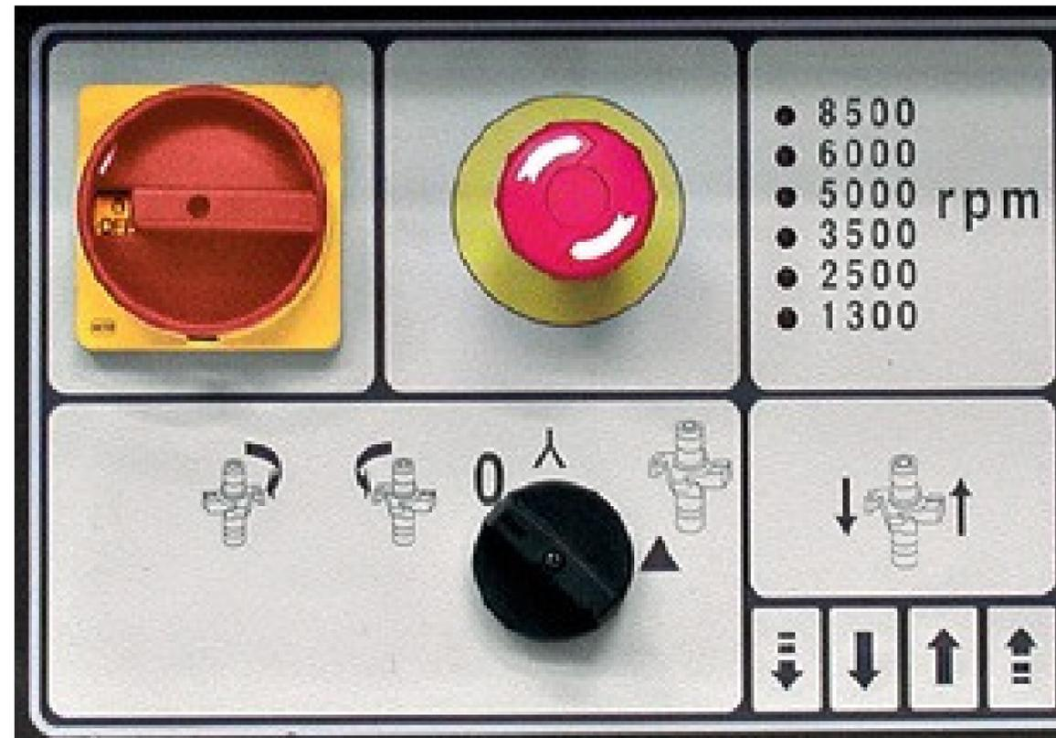
Controlo da tupa está orientado para o operador. A altura do veio é indicada por meio de um display mecânico com precisão de 1/10 mm que permite um ajuste rápido sem a necessidade de realizar nenhum teste de usinagem.
