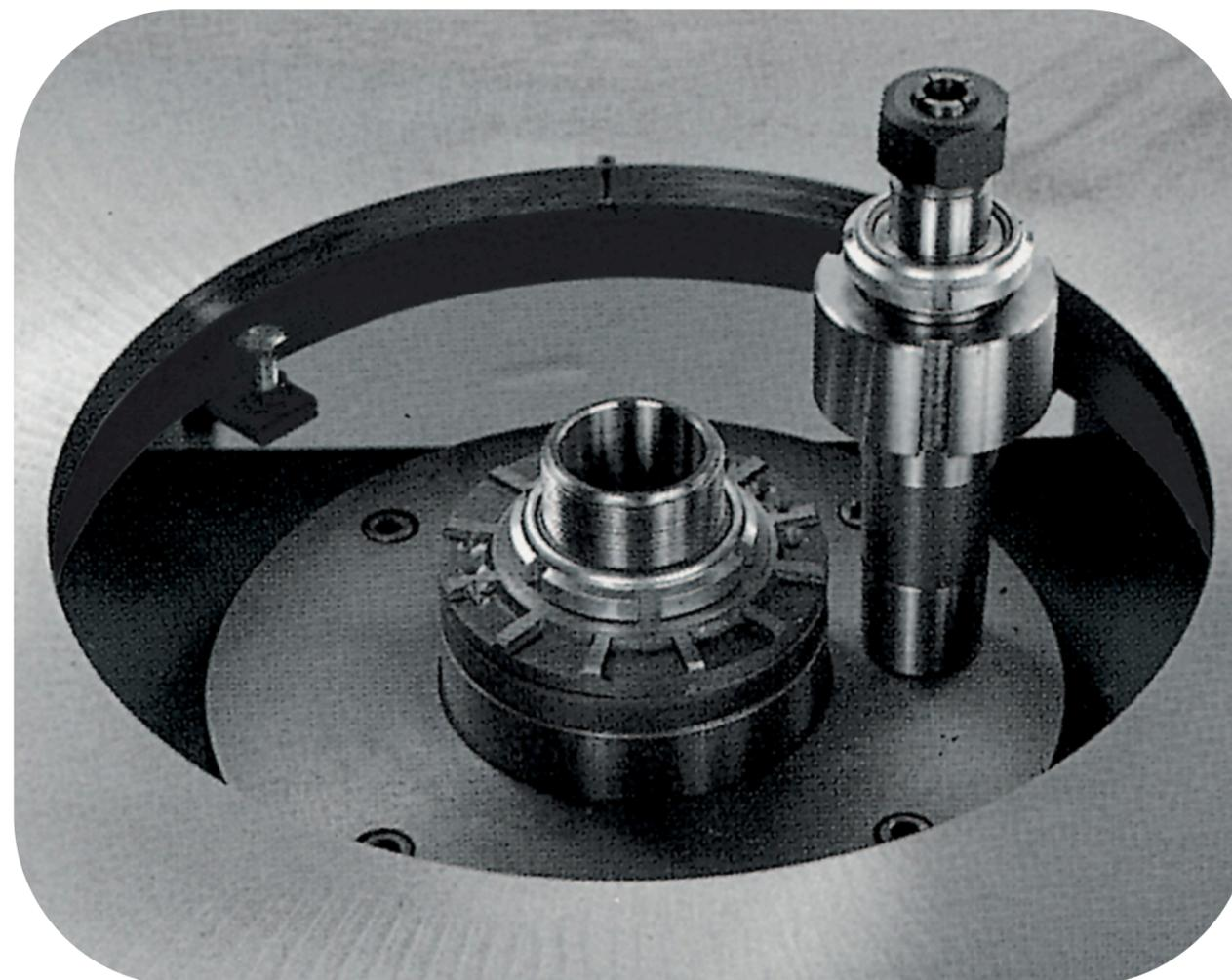
Árvore inclinável de  $+45^{\circ}/-5^{\circ}$  com leitura de inclinação no visor gravitacional e movimentação com volante.
