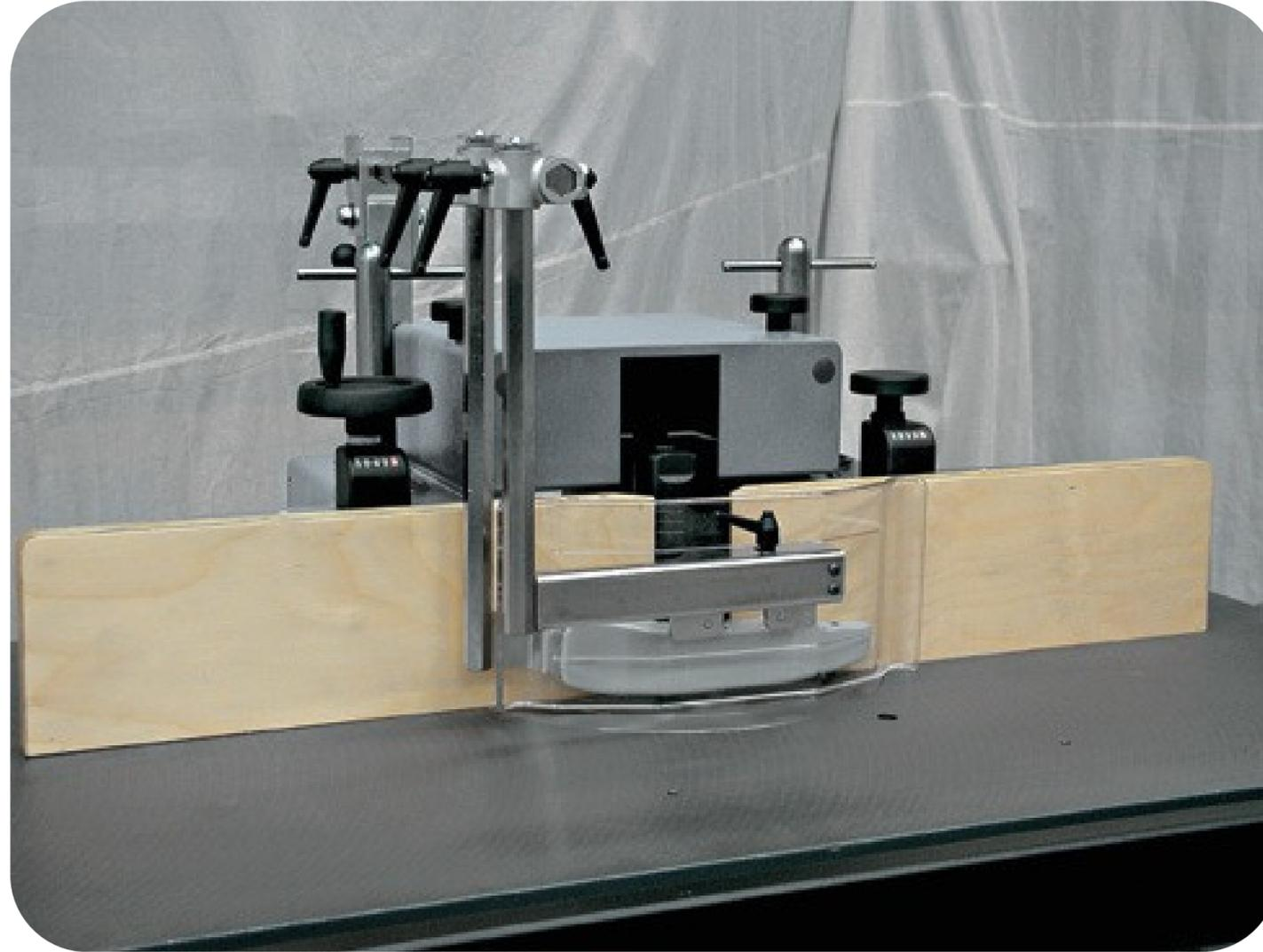
Proteção - movimentada por fuso que permite a leitura do posicionamento correto da paralela em comparação com a ferramenta de corte, com precisão decimal, eliminando assim as usinagens de teste após a troca de ferramenta.
