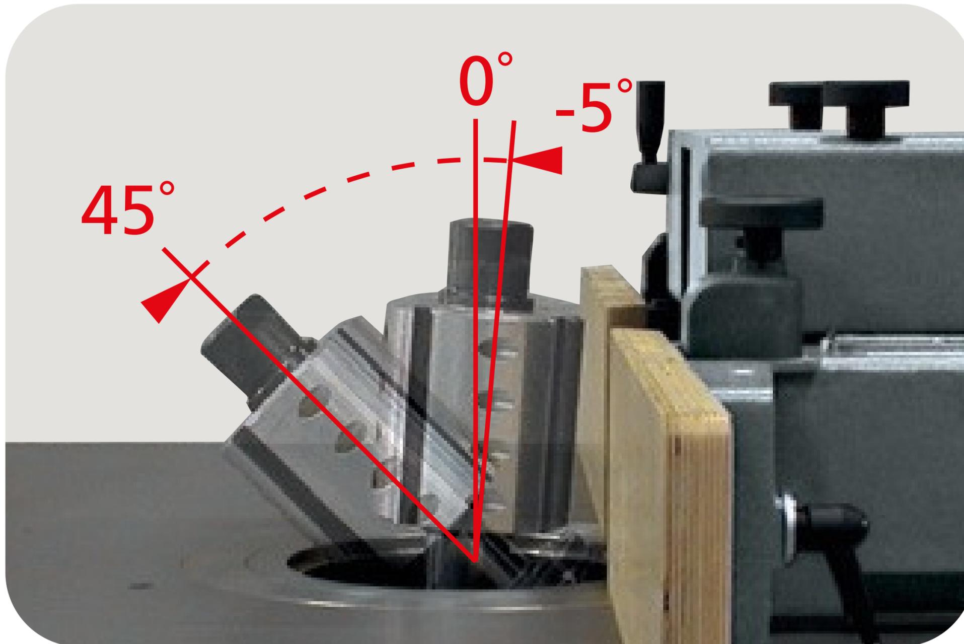
Árvore inclinável de  $+45^{\circ}/-5^{\circ}$  com leitura de inclinação no visor gravitacional e movimentação com volante.
