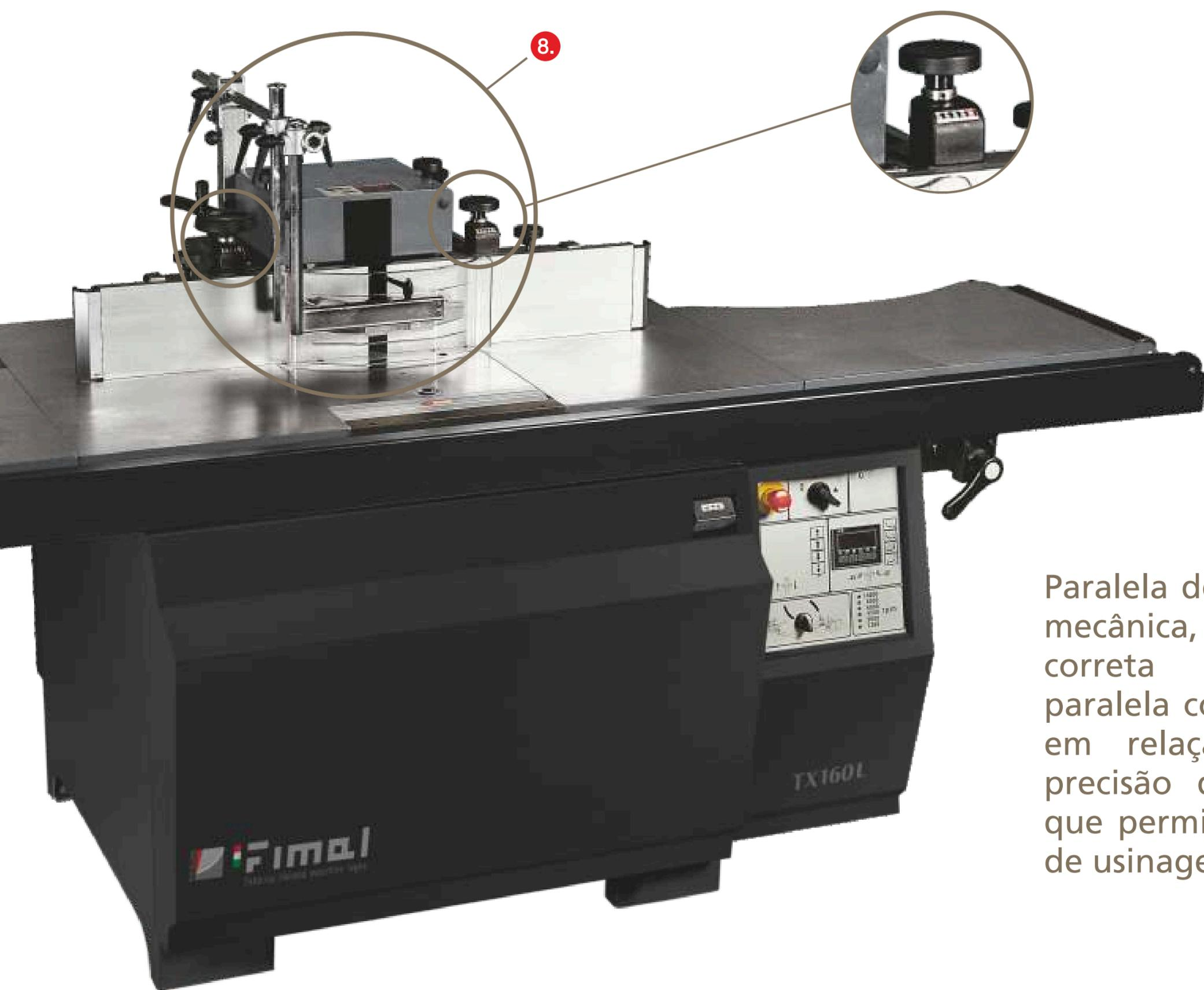
Paralela de tupa com programação mecânica, visores que permitem a correta localização tanto da paralela como do plano de entrada em relação à ferramenta, com precisão decimal de milímetro, o que permite a eliminação de testes de usinagens.
