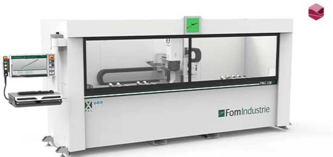
O centro de usinagem com 4 eixos controlados FMC 230 foi projetado para executar usinagens de furação e fresamento em perfis de alumínio ou aço (espessura máx. de 2 mm). O trocador de ferramentas automático de 10 posições de série e a regulagem dos mordentes das morsas que não exige o uso de chaves agilizam o processo produtivo. A pedido podem ser ativadas as funções: “Usinagem de perfis acima da medida”, “Flowdrill”, “Usinagem de 2 peças” e “Usinagem com X-PAL”.
