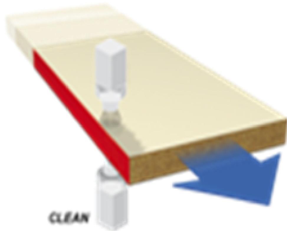
A utilização do limpador, em combinação com o grupo raspador de cola, permite a eliminação de qualquer resíduo que fique sobre o painel.
