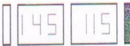
Em seguida, rodar a roda para que a luz indicadora exterior fique acesa e vertical sobre o eixo principal, retirar 115 g de chumbo do aço da roda (conforme imagem)
